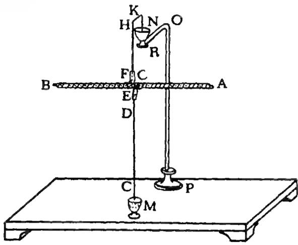
Рис. 2. Первый прибор для исследования влияния магнитного поля Земли на соленоид. АВ — соленоид, намотанный на тонкую стеклянную трубку и подвешенный подобно стрелке компаса. Прибор оказался недостаточно подвижным, и ожидаемый эффект зарегистрирован не был. (Рисунок Ампера)
