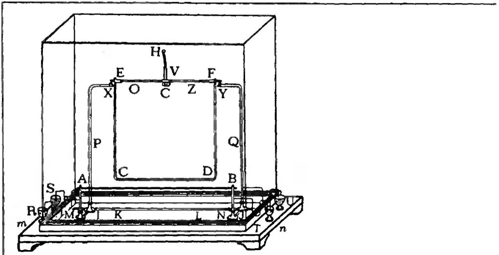
Рис. 1. Прибор для изучения взаимодействия проводников с током. АВ — неподвижный проводник, EDF — подвижный проводник, укрепленный на стеклянной оси EF. Для защиты от воздушных колебаний прибор накрыт стеклянным колпаком. (Рисунок Ампера)
