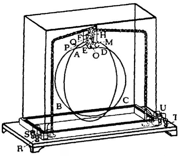
Рис. 3. Прибор для исследования влияния магнитного поля Земли на виток с током. ABCD — подвижный виток с током. Второй (неподвижный) виток большего радиуса фиксировал вертикальную плоскость, перпендикулярную к магнитному меридиану в данной точке. При включении тока виток ABCD поворачивался до совпадения с неподвижным витком. (Рисунок Ампера)
